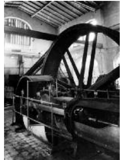
Schwungrad der alten Dampfmaschine, die zunächst alle Webstühle antrieb. Sie wurde durch Motoren ersetzt, die für gleichmäßigeren Lauf sorgten
