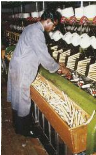
Nishit als Praktikant bei der Firma Brügelmann in Cromford. Hier überprüft er gerade die Schusspulautomaten, hergestellt von der Firma Schlafhorst in Mönchengladbach
